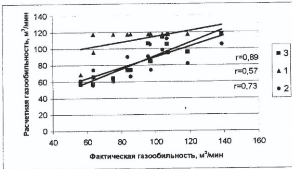
Рис. 6 – Значения коэффициентов корреляции между расчетной и фактической газообильностью по трем моделям: 1 – для первой модели; 2 – для второй модели; 3 – для третьей модели
